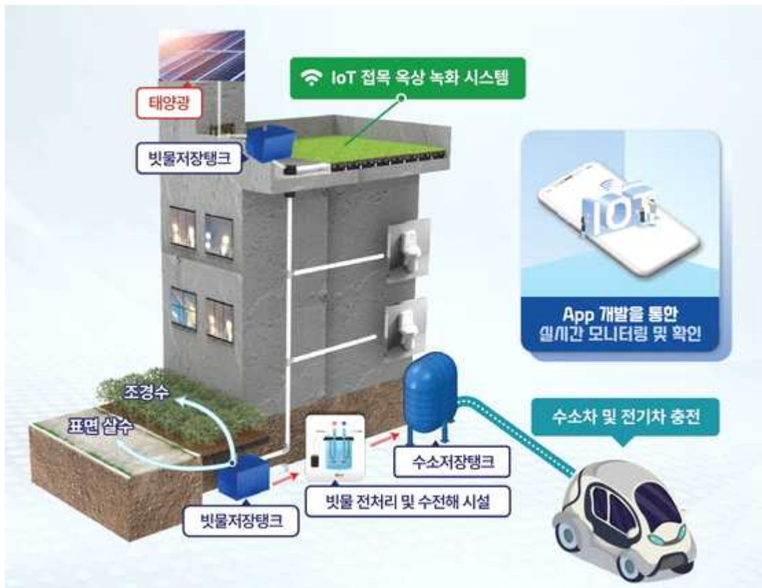
〈그림 2-31〉 고양시 빗물저금통 활용 열섬현상 저감 시스템
